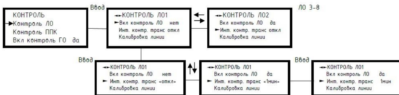
Рисунок 33. Установка интервалов контроля ЛО при трансляции.
