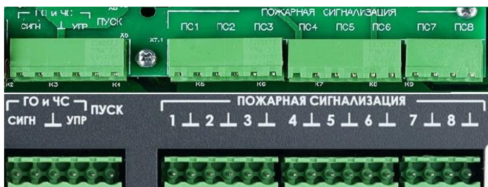
Рисунок 15. Клеммы для подключения системы ПС, ГО и ЧС.
