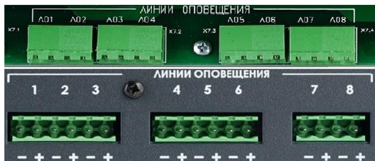
Рисунок 17. Клеммы для подключения речевых оповещателей (рупорных громкоговорителей).
