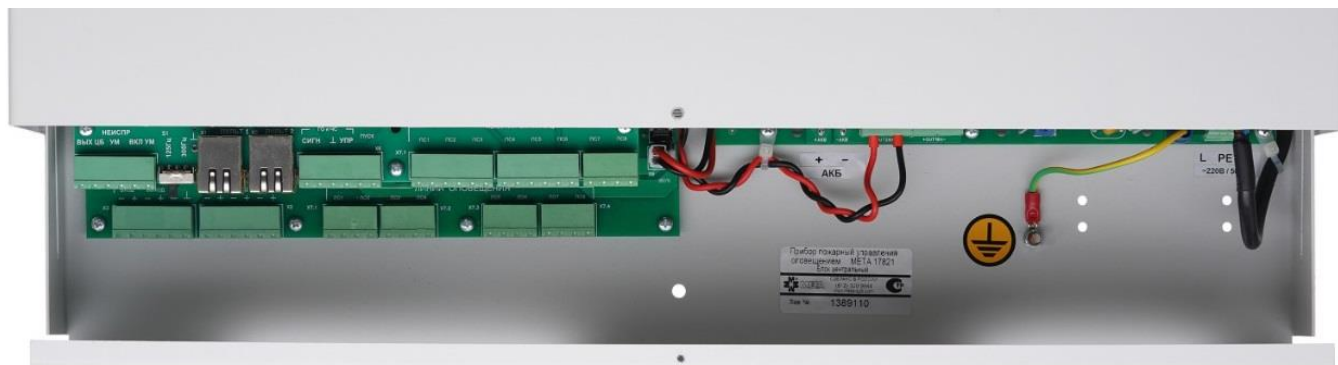
Рисунок 3. Клеммы (элементы коммутации) ЦБ МЕТА 17820/17821.
